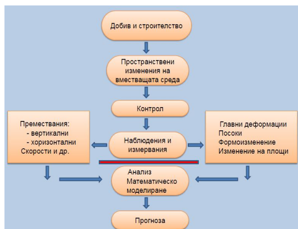
Фиг. 1. Принципен модел на изучаване на поведението на скалния масив и приложението на маркшайдерските методи за тази цел [19]
