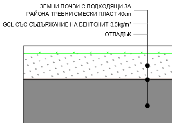
Фигура №6 – Рекултивация на депо за неопасни отпадъци от химическата повърхност. Горен изолиращ екран, съставен от: земни почви и GCL
