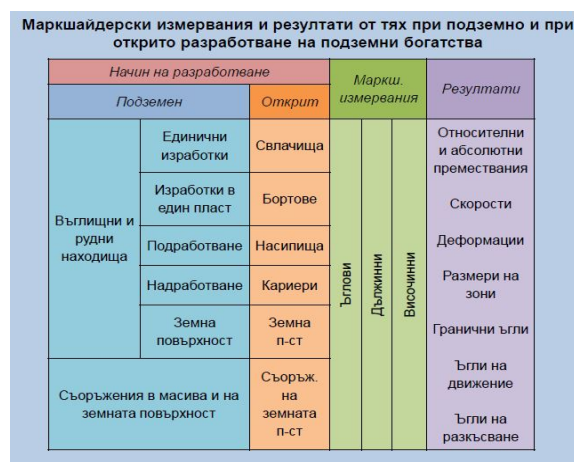
Фиг. 2. Обща схема на маркшайдерските измервания и резултатите от тях при изследване на геомеханични процеси [19]
