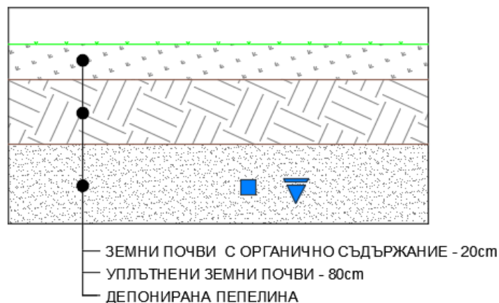
Фигура №7 – Рекултивация на депо за неопасни отпадъци от производство от ТЕЦ (Сгуроотвал). Горен изолиращ екран, съставен от два пласта почва
